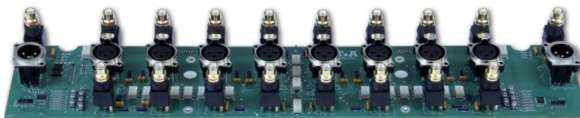
Die High-End Anschlussbuchsen werden direkt auf die Platine gelötet und fest mit der Aluminiumrückwand verschraubt.
