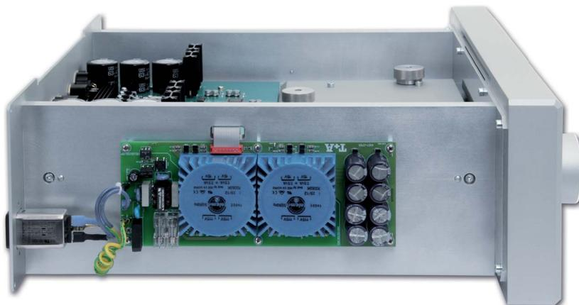
Doppeltrafo-Hochleistungs-netzteil für den Analogbe-reich, perfekte Abschirmung im außenliegenden Gehäuse-Compartment.
