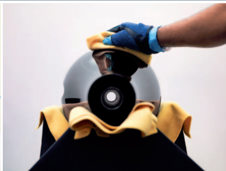
Kopfwechsel: Die alte Form des „Marlan“-Kopfes beim Mitteltöner wurde ausgetauscht. Die noch stromlinienförmigere Version heißt schlicht und treffend „Turbine Head“.
