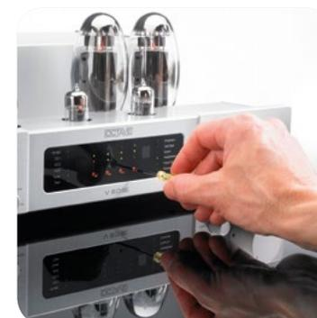
**Über die LED-Anzeige im Display ist der optimale Ruhestrom der Leistungsröhren leicht einstellbar**
