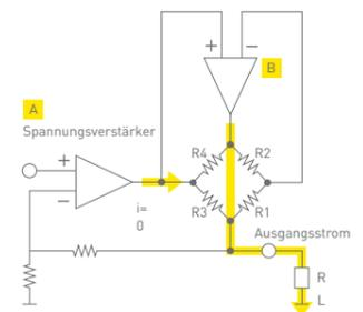
**A** Die Eingangsstufe dient der reinen Spannungsverstärkung. Das Eingangssignal wird feinfühlig verstärkt. Ein hochwertiger Operationsverstärker kommt hier zum Einsatz.
