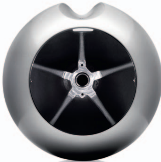
Das Kopfteil mit der eingearbeiteten Mitteltöner-Röhre ist jetzt aus einem Alu-Teil gegossen und sensationell resonanzarm. Oben die Ausbuchtung für die Aufnahme des Hochtönergehäuses, mittig das Befestigungsgewinde für den von hinten gehaltenen Mitteltöner.
