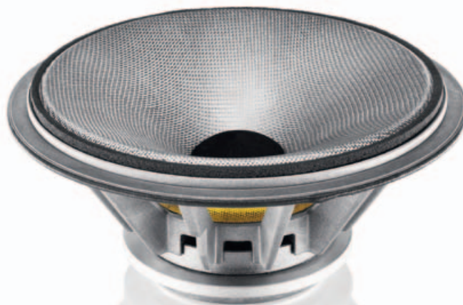
Der Mitteltöner aus dem Spezialgewebe Continuum ist sickenlos auf Schaumstoff aufgehängt und besitzt mittig einen bedämpfenden Gummipflug gegen Interferenzen.
