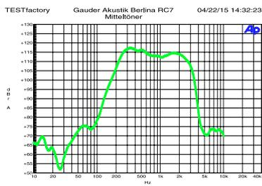
**WIE IM BILDERBUCH:** Der Einsatz von 17 Bauteilen allein beim Mitteltöner (Schaltbild) führt im Messlabor (links) zu perfekt verlaufenden Flanken. Aus klanglichen Gründen sind die Spulen und Kondensatoren in mehrere Teile gesplittet.
