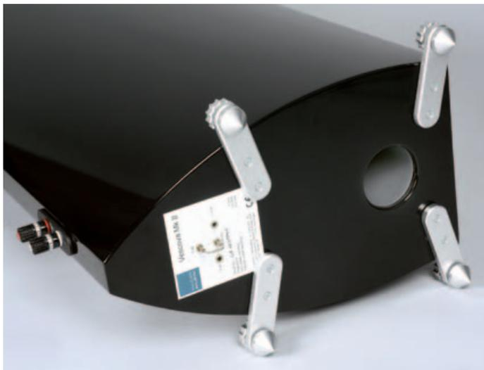
Neu trifft alt. Neu: Die Ausleger, sogenannte Spike-Extender, sorgen für eine größere Stellfläche und einfache Spike-Justage von oben. Ein wichtiger Punkt, da der Abstand zum Boden angesichts der nach unten gerichteten Bassreflex-Öffnung essenziell über den Klang entscheidet. Alt und bewährt: Über ein Steckmodul kann der Bass um 1,5 Dezibel angehoben, neutral belassen oder gesenkt werden.
