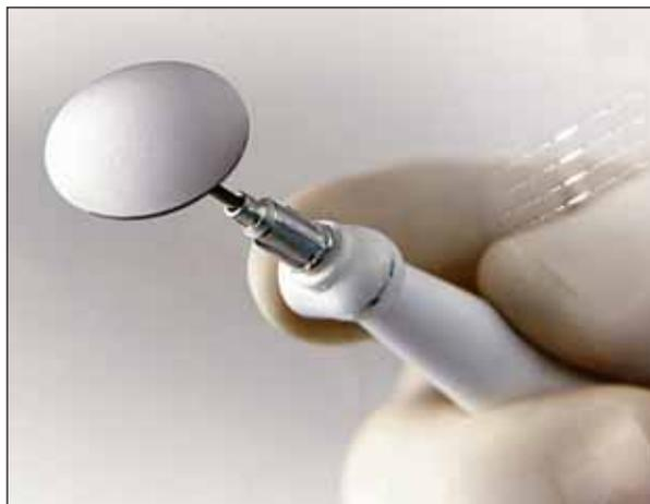
Die 40 Mikrometer dünne, bruchempfindliche Diamantmembran muss bei der Fertigung mit einem Vakuumsauger gehandhabt werden
