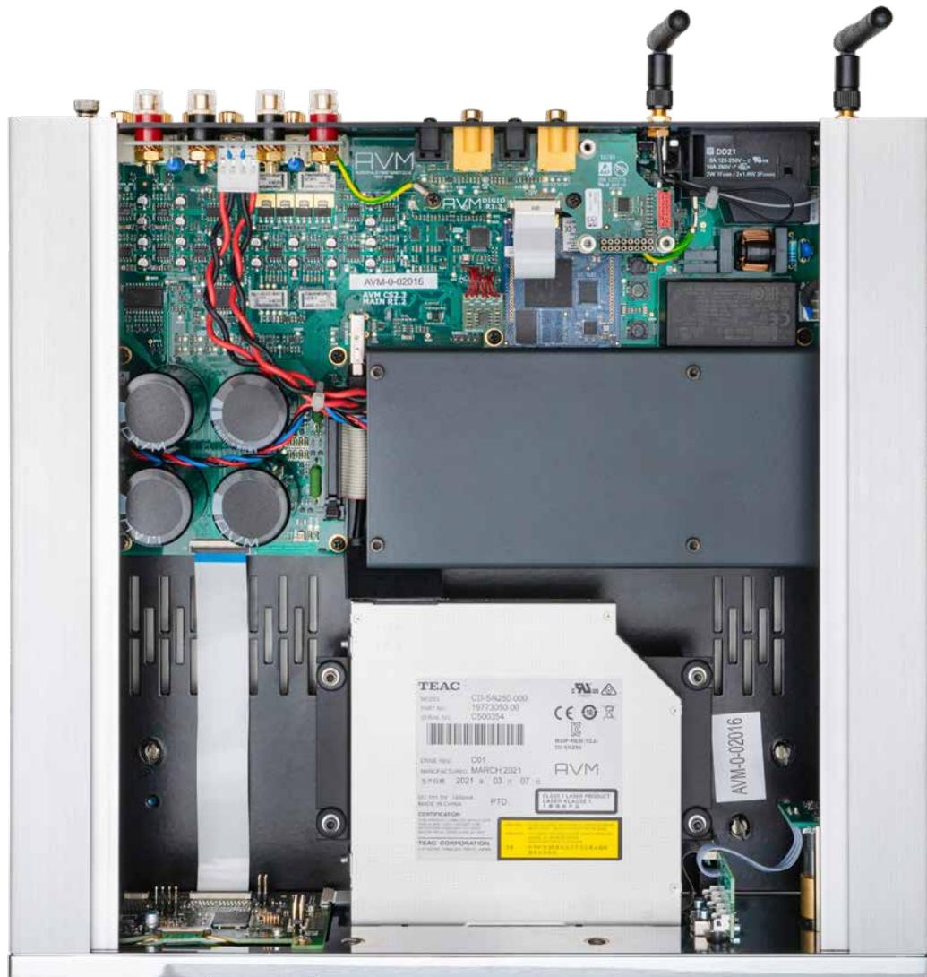
Mal sehen, ob Sie folgen können: Die CS 2.3 besitzt ein eigenes Stromfilter, das hinter der schwarzen Abdeckung direkt am Netzanschluss untergebracht ist. Auf der kleinen blauen Platine ist die neue Streamingengine verstaubt. Und die liegt hier goldrichtig, denn direkt daneben sitzt der D/A-Wandler. Ganz unten links im Gehäuseinneren können Sie derweil eine Kette winziger Kondensatoren erspähen. Die gehören zum integrierten Phonoentzerrer.
