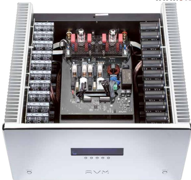
**Der satte 42 Kilogramm wiegende AVM SA 8.3 bietet eine ganze Armada an Leistungs-MOS-FETS und Elektrolytkondensatoren auf jeder (Mono-) Seite, dazu kanalgetrennte 1000-VA-Trafos.**
