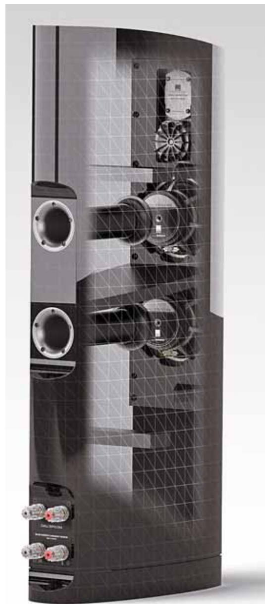
Die Zeichnung zeigt das Zwei-Kammer-System für die Tieftöner. Die Reflexrohre reichen jeweils dicht an diese heran
