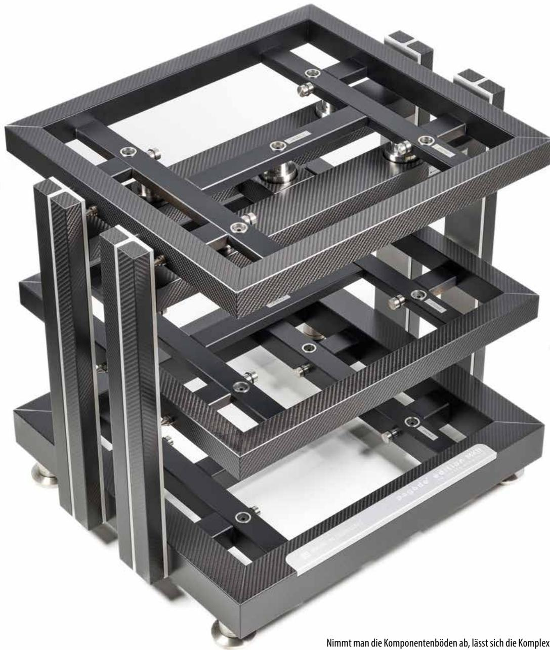
Nimmt man die Komponentenböden ab, lässt sich die Komplexität der Konstruktion zumindest erahnen. Gut zu erkennen sind im Bild die in die Tragrahmen eingelassenen Metallaufnahmen für die Keramikugelbolzen, die die Böden aufnehmen. Bei den waagrecht eingelassenen Metallzylindern handelt es sich um die Endstücke der Resonatoren, die für jede Ebene separat abgestimmt sind.
