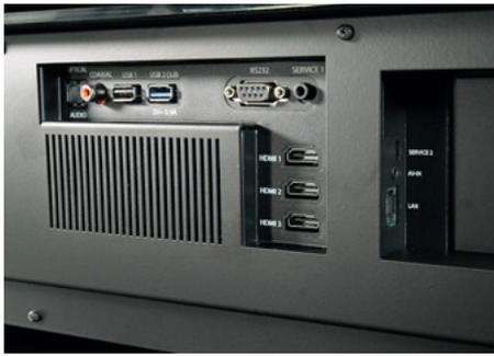
Alle Eingänge befinden sich auf der Rückseite des xTV4K, so dass von der Couch kein Kabelsalat zu sehen ist. Drei HDMI-Eingänge sind üppig bemessen, gleichwohl wird nur HDMI 1 ARC unterstützt. An Service 1 kann ein Kopfhörer angeschlossen werden. Eine der beiden USB-Schnittstellen versorgt den Roku Media-Player mit Strom. Über Optical und Coaxial lässt sich der Ton der Apps ausgeben. RS232 dient der Steuerung für eine externe Fernbedienung.
