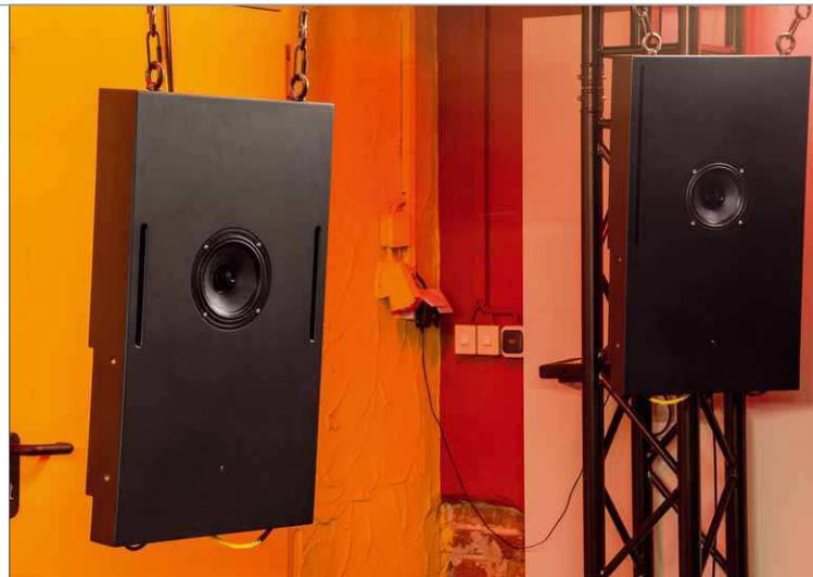
Die flachen CCRM 6 Mk II mit 6,5-Zoll-Koaxen sind fliegend aufgebaut, das heißt sie hängen an Stahlseilen und Ösen an der Decke und den Wänden
