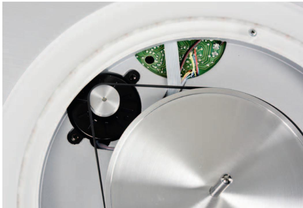
Oben: Der fest verschraubte Motor überträgt seine Kraft per Rundriemen auf den Alu-Subteller. Oben im Bild, fast unsichtbar, die LED-Beleuchtung.
