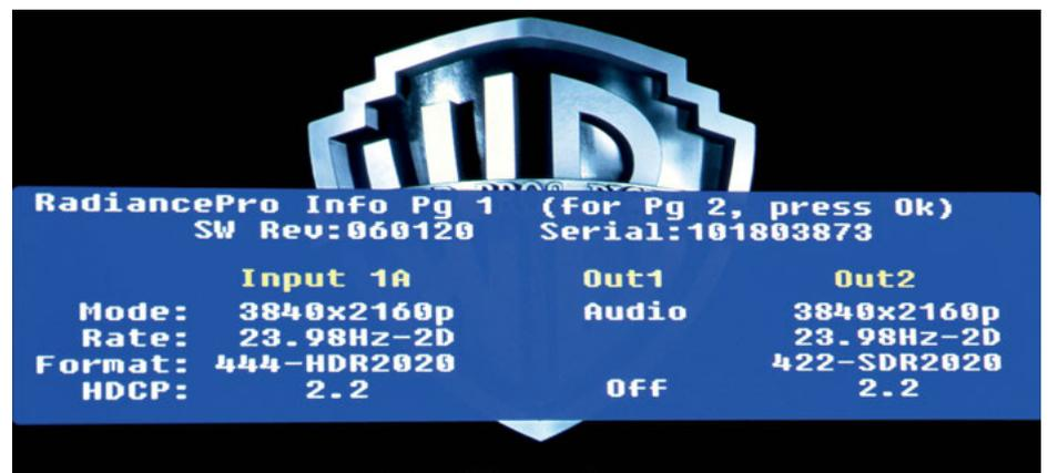
Via Info-Taste wird auf dem On-Screen-Menü angezeigt, welches Eingangssignal am Radiance Pro anliegt und in welcher Form er es ausgibt.
