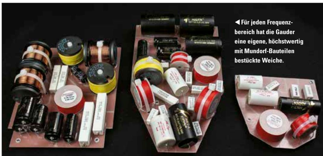
◀ Für jeden Frequenzbereich hat die Gauder eine eigene, höchstwertig mit Mundorf-Bauteilen bestückte Weiche.
