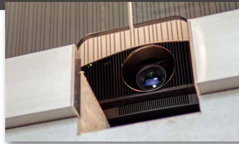
Für das perfekte Bild auf der Leinwand sorgt der Sony 4K-Laser-Projektor VPL-VW 760 ES mit adaptiver Iris für erhöhten Kontrast
